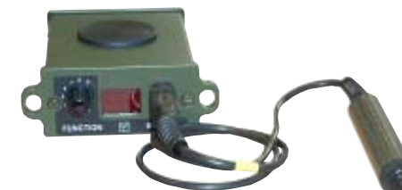
Boucle de détection d'UXOs 60 1 = Bombe de 50 kg à 1,7 m de profondeur 2 = Grenade de 75 mm à 1,2 m de profond.
