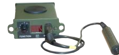
60-cm-UXO-Spule 1 = 50 kg Fliegerbombe in 1,7 m Tiefe 2 = 75 mm Panzergranate in 1,2 m Tiefe
