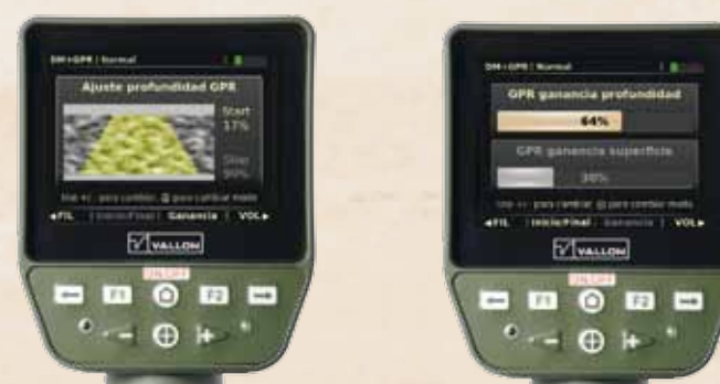
Configuración individual del radar (GPR). Punto Inicio y punto Final de la zona de detección del GPR, ganancia de profundidad y ganancia superficie.
