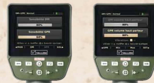
Ajustes individuales de sensibilidad y del volumen del detector de metales y del radar (GPR).
