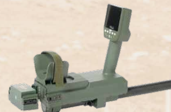
La batería Li-polímero de alta capacidad se coloca en la unidad electrónica.
