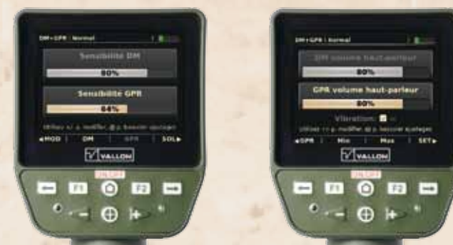
Réglage individuelle de la sensibilité et du volume du détecteur de métaux et du radar.
