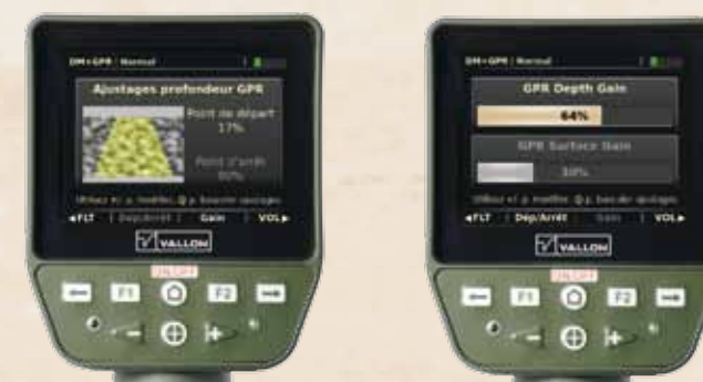
Configuration individuelle du radar (GPR). Point de départ et point d'arrêt de la zone de détection du radar, gain surface et gain profondeur.
