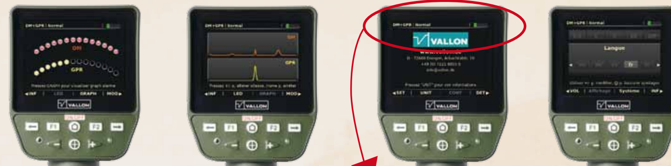
Représentation graphique des différents des alarmes, soit par indication LED ou par indication graphique.
