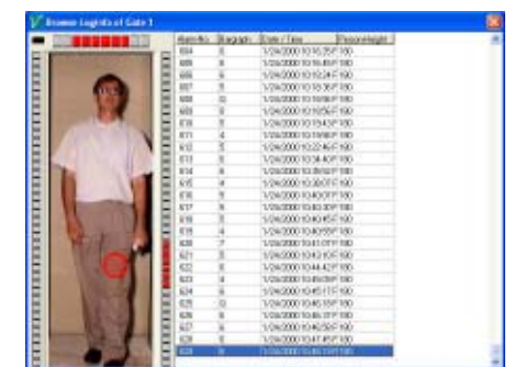
L'exemple montre un portique à l'écran. La représentation de la personne est la prise vidéo originale de celle-ci à l'entrée du portique. Le cercle rouge et les led situés de part et d'autre du portique représentent l'objet là où il est placé et sa grandeur.
