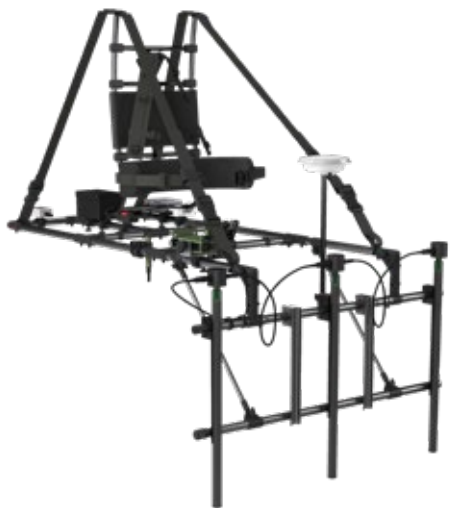
^ Estructura portante VXP3 estrecha: alojamiento de 3 sondas con una distancia de 50 cm o 4 sondas con una distancia de 33 cm (fig. incluye componentes opcionales)
