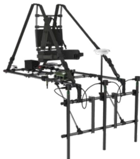
^ Cadre de portage VXP3 étroit – peut accueillir 3 sondes espacées de 50 cm ou 4 sondes espacées de 33 cm
